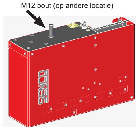
Zet de Smartload vast in de opstelling mbv de M12 bout die in het hart van de hechtunit is aangebracht. Het aandraaimoment is 125Nm.
